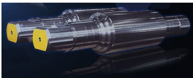
改善グレンロール(熱間薄板圧延用ロールの外観)
