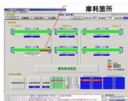
トロリ線監視システムモニタ(例)
