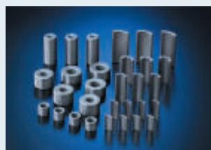
希土類磁石NEOMAX、フェライト磁石は、主にモーターに使われます。当社が1982年に発明したNEOMAXは、フェライト磁石の約10倍の磁力を持ち、モーターの小型化、高効率化で電動化社会の実現に貢献してきました。現在も材料の省重希土類化の研究開発などで業界をリードしています。フェライト磁石は、資源が豊富な酸化鉄を主成分としています。フェライト磁石として世界最高クラスの磁気特性を実現しており、こちらもモーターの小型化、高効率化に貢献しています。2022年にはxEV駆動モーター用磁石としての可能性を世界に示しました。
