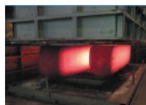
保温槽を用いた焼鈍作業
