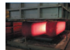
保温槽を用いた焼鈍作業
