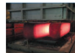
保温槽を用いた焼鈍作業
