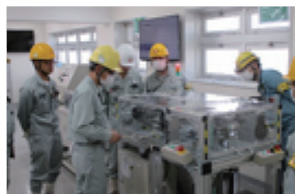
回転物の巻き込まれ疑似体感学習装置 布や紐を機械装置の回転している軸に巻き込まれた場合の状況を実際に体感することができる。家庭用扇風機相当のモーターでも減速することにより強い張力が発生する。
