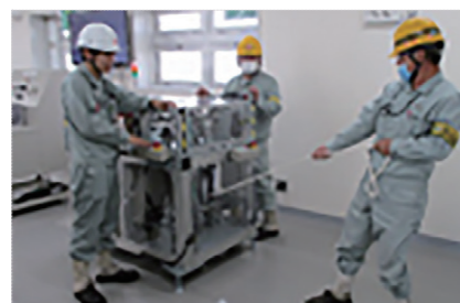
回転物の巻き込まれ疑似体感学習装置 布や紐を機械装置の回転している軸に巻き込まれた場合の状況を実際に体感することができる。家庭用扇風機相当のモーターでも減速することにより強い張力が発生する。
