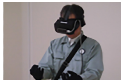
VR装置(Virtual Reality装置) 仮想現実空間上で各作業の危険性を体感することができる。労働災害を疑似体験することで、危険に対する感受性を高めると同時に、身体に記憶させることが可能。
