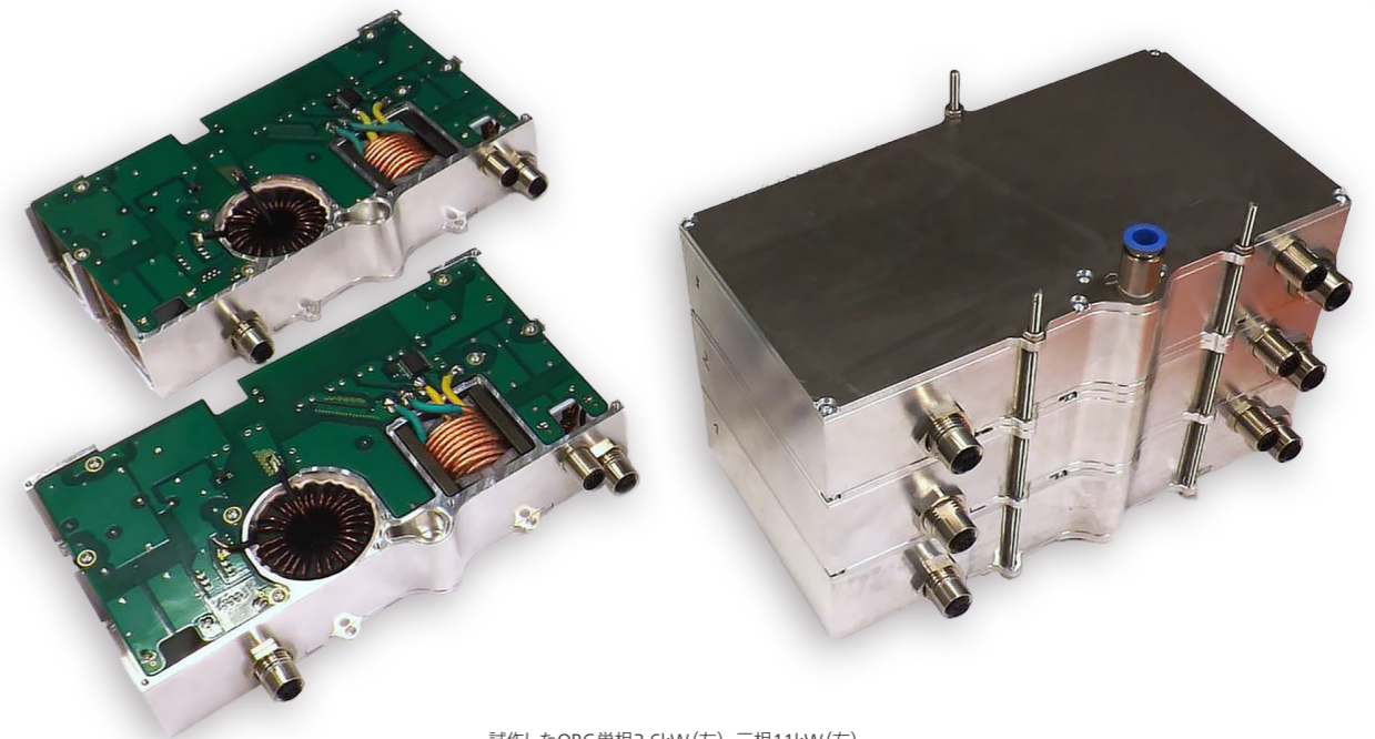
試作したOBC単相3.6kW（左）、三相11kW（右）
