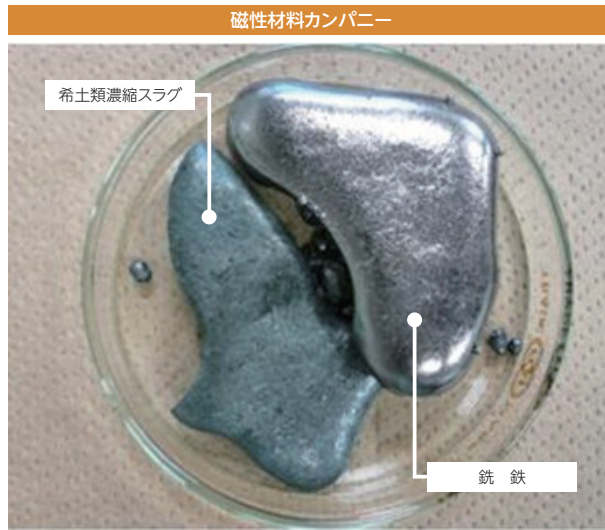
炭素熱還元法で精製したスラグ(左)と銑鉄(右)
