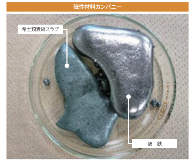
炭素熱還元法で精製したスラッジ(左)と鉄鉄(右)
