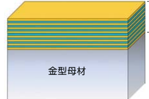
ナノスケール(10億分の1メートルレベル)の薄膜を交互に積層した構造
