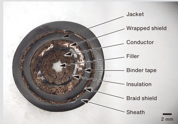
図2 開発ケーブル断面写真
