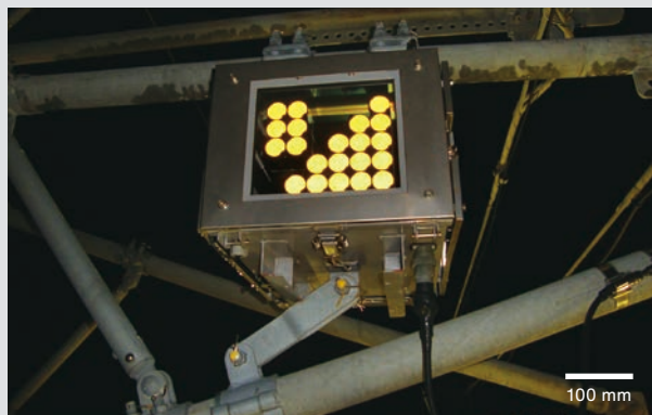
図3 柱上式摩耗検知装置
