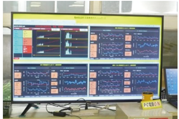
図3 生産量・製造リードタイム 実績管理用ダッシュボード
