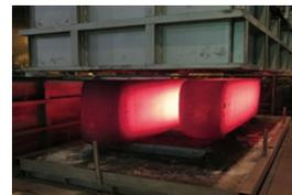
保温槽を用いた焼鈍作業
