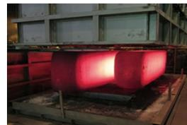
保温槽を用いた焼鈍作業
