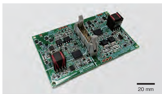
図2 ローム製評価用ゲートドライブ基板の外観 Fig.2 Appearance of ROHM evaluation gate drive board
