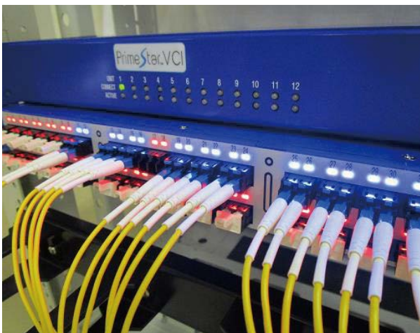
図3 インライン光ファイバー通信回線監視装置(新製品) Fig. 3 Inline real-time optical fiber monitoring system
