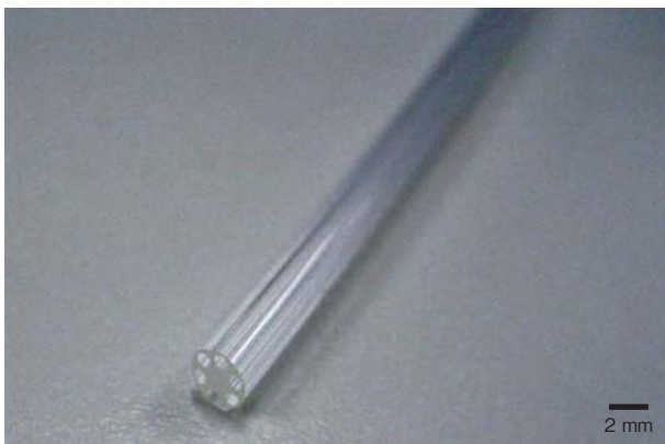
図1 マルチルーメンチューブ外観 Fig. 1 Appearance of multi-lumen tubing
