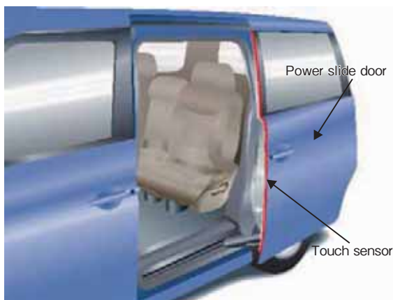
図1 挟み込み防止用感圧センサーの使用箇所の例 Fig. 1 Application of the touch sensor
