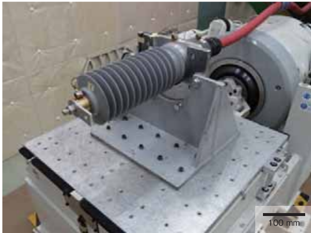
図 8 振動および衝撃試験の状況 Fig. 8 Shock and vibration test setup
