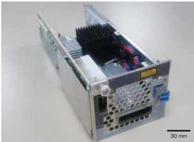
図3 100G カードの内部構造 (上部カバー取り外し) Fig.3 Interior structure of 100G transport line card without top cover
