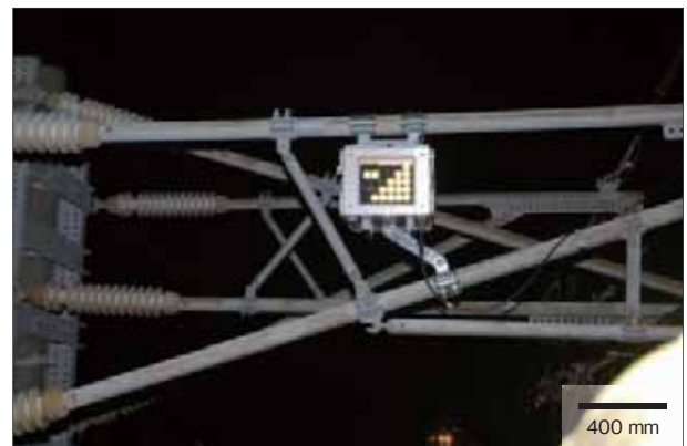
図2 光ファイバー式警報トロリ線の摩耗検知装置(柱上配置型) Fig. 2 Optical fiber wear-detection device
