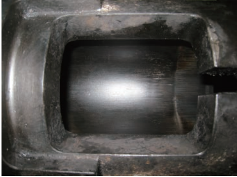
湯口直下の溶損なし
