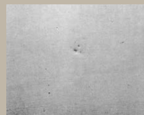
防錆不良によるピンホール模様 Pinhole texture by inappropriate rust proof.
