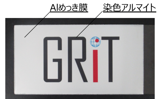
図1 Alめっき+アルマイト（陽極酸化）後の外観 *グローバル技術革新センター（GRIT）ロゴ
