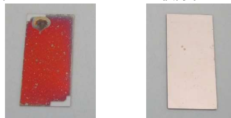
図 高温高湿試験後の外観(膜厚:0.2μm)
