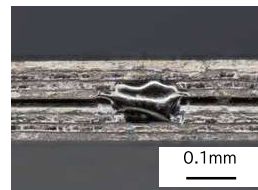
(a)アモルファス (積層接着品側面溶接)
