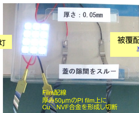
図:半田ボール接合テスト後の外観
