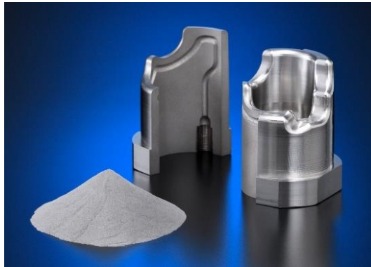
日立金属の3Dプリンター用粉末材と成形例
