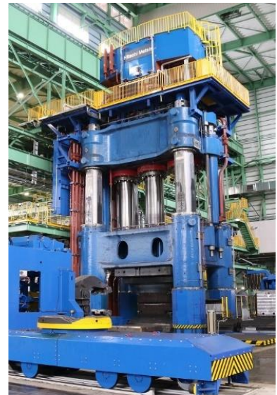
安来工場 1万トン自由鍛造プレス機 (島根県安来市)
