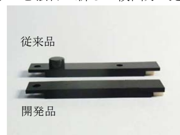
写真：超薄型トナーセンサー例 （上：従来品 下：開発品）
