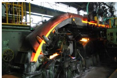
連続鋳造圧延設備
