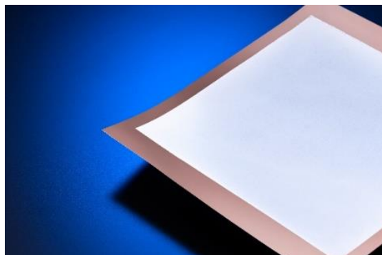
Alectro のサンプル外観（白色部が電析したアルミニウム） （左：金属ブロックの全面に Alectro を施したサンプル、右：銅箔に Alectro を施したサンプル）
