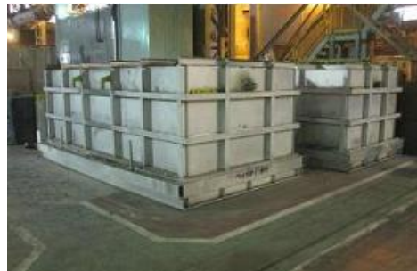
保温槽を用いた焼鈍状況
