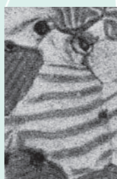
フェライト磁区観察イメージ図 Image of Magnetic Domain in Sintered Ferrite
