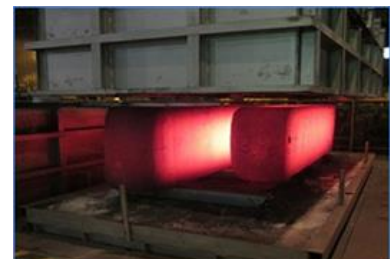
保温槽を用いた焼鈍作業
