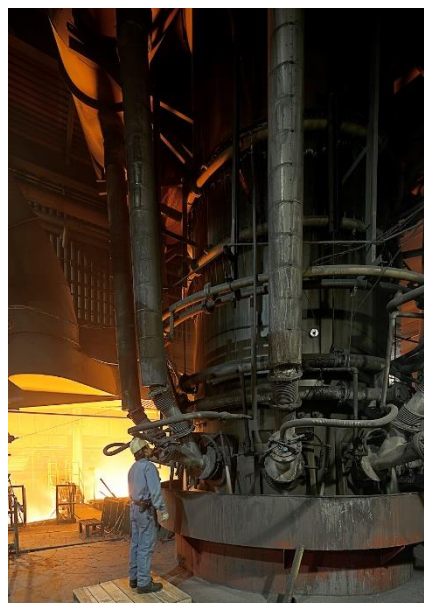
キュポラの燃焼状態の確認
