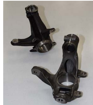
高靱性ダクタイル鋳鉄「オメガナックル®」の外観写真
