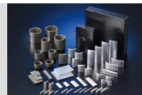
ネオジム磁石は高性能ですが、耐熱性向上には重希土類の添加が必要です。当社は、重希土類をまったく使用せず、EV(電気自動車)の駆動用モーターにも使用可能な高残留磁束密度(Br)と高保磁力(HcJ)を両立した高性能重希土類フリーネオジム焼結磁石を開発しました。重希土類の資源枯渇リスクを回避するとともに、モーターの高トルク化や小型化、高効率化による省エネルギー、CO<sub>2</sub>排出量削減に貢献します。
