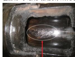
湯口直下の溶損あり
